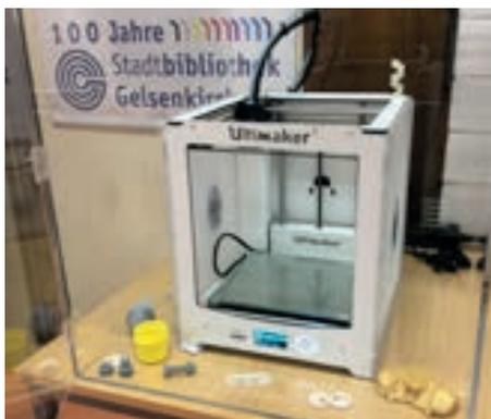
Eine Dimension mehr als diese 2D-Technologie bietet seit einigen Jahren der 3D-Druck. Hiermit werden Modelle nach einer dreidimensionalen digitalen Vorlage aus sogenanntem Kunststoff-Filament „gedruckt“. Ein solcher 3D-Drucker ergänzt seit 2015 den Makerspace im Bildungszentrum Gelsenkirchen, der als Kooperationsprojekt der Stadtbibliothek und der Volkshochschule initiiert wurde.
